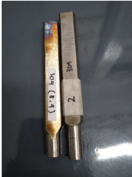
Gambar 4. 9 Hasil Uji Tarik Sampel 2
