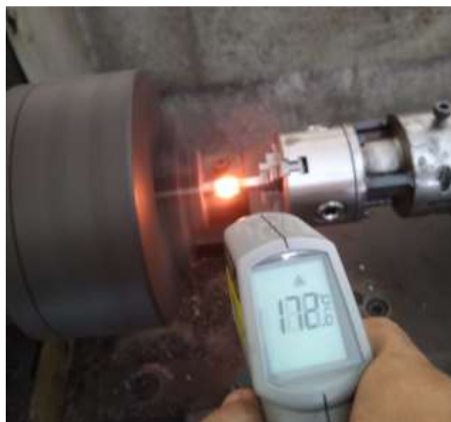
Gambar 4. 3 Pengetesan Suhu Pengelasan gesek
