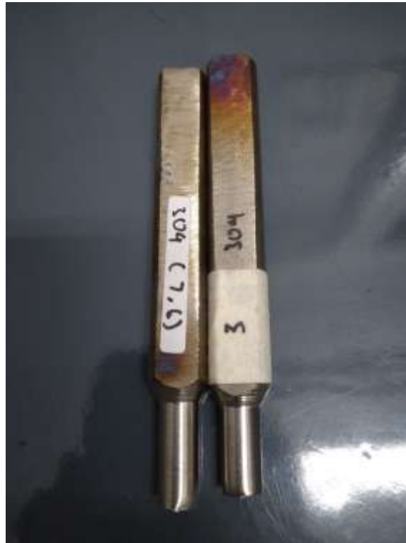
Gambar 4. 10 Hasil Uji Tarik Sampel 3
