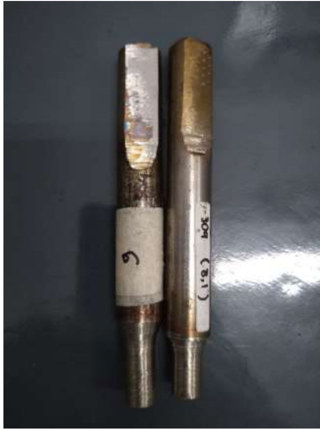
Gambar 4. 16 Hasil Uji Tarik Sampel 9
