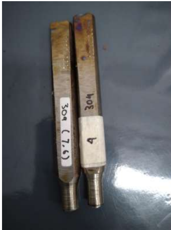
Gambar 4. 11 Hasil Uji Tarik Sampel 4
