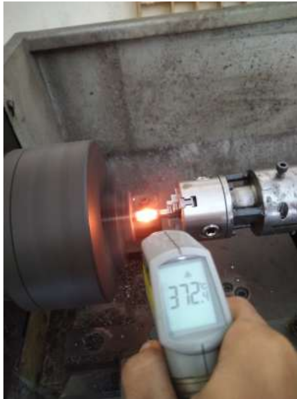
Gambar 4. 2 Pengetesan suhu pengelasan gesek
