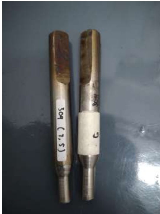
Gambar 4. 13 Hasil Uji Tarik Sampel 6
