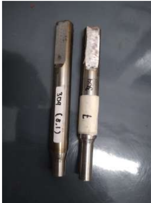
Gambar 4. 14 Hasil Uji Tarik Sampel 7
