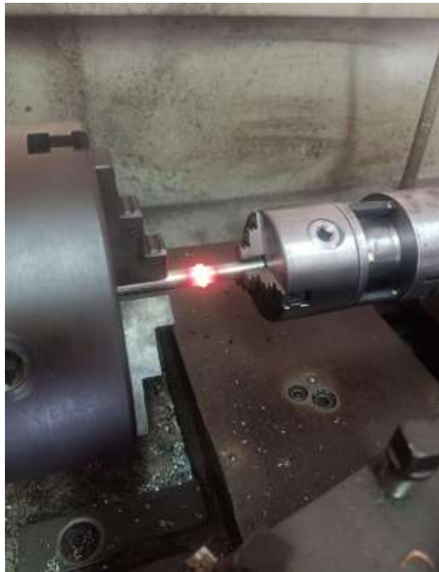
Gambar 4. 1 Proses Penyambungan Benda Uji AISI 304 dan AISI 304 ( friction welding )
